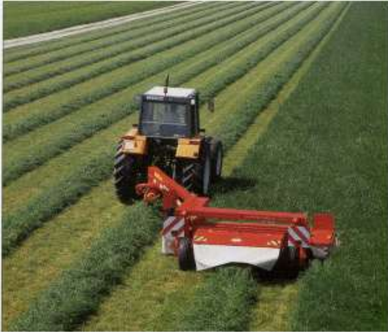
Figura 1 – Fase de corte ou ceifa da forragem a ser fenada. Fonte: Catálogo KUHN (Segadora condicionadora)
